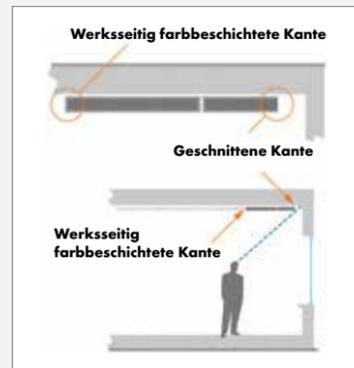
Richten Sie die werksseitig farbbeschichteten Kanten auf die Flucht aus und die geschnittene und gestrichene Kanten auf die Wände bzw. auf die weniger sichtbaren Bereiche des Raums aus.
